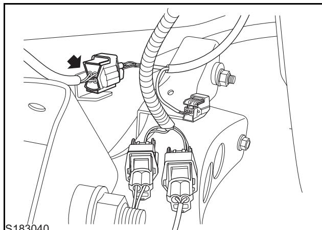
19 断开燃油泵连接器的连接。
