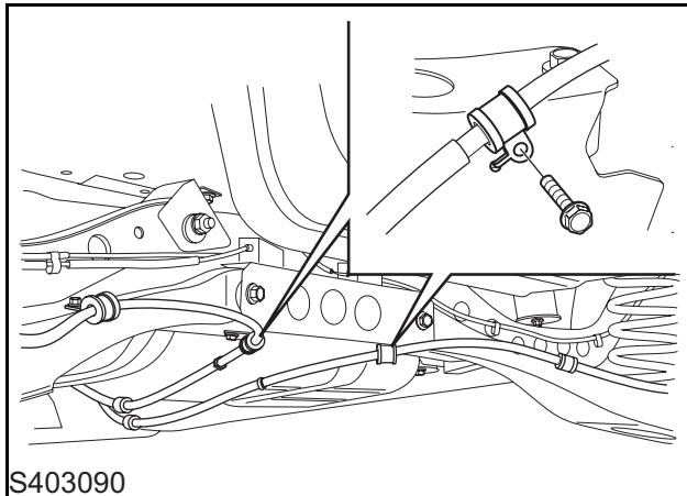
13 拆下两个将手制动拉索固定到后副车架上的螺栓。
