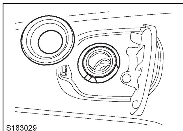
9 拿开将加油管加注口固定到加注孔的护套。
