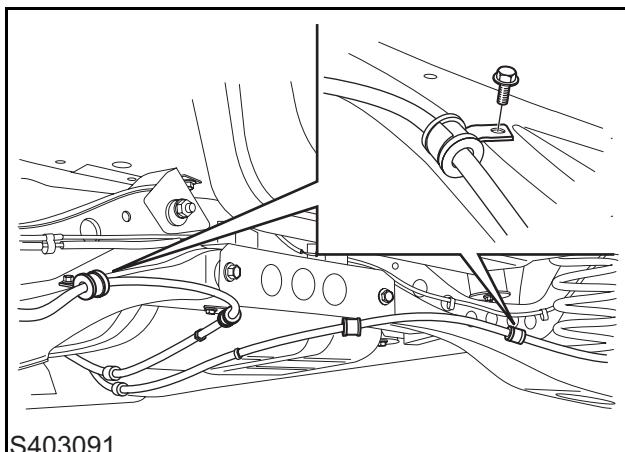
14 拆下两个将手制动拉索固定到后悬架上摆臂上的螺栓。将手制动拉索移到一边以便操作燃油箱。
