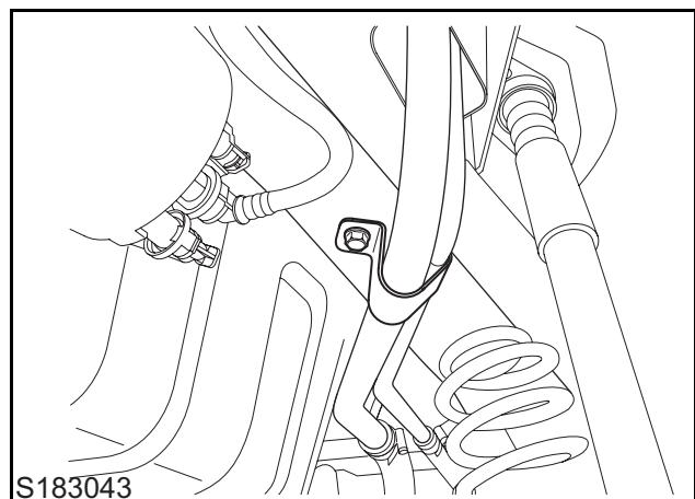
2 从轮罩下面将加油管加注口固定到车身上并拧紧螺栓至 7-10Nm。
