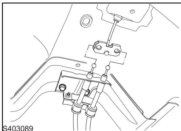
11 拆下将手制动调节器支架固定到车身的两个螺栓并拿开调节器。
